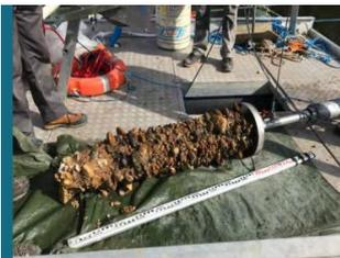
des carottages cryogéniques pour échantillonner et étudier précisément les fractions granulométriques dans les secteurs de dépôt graveleux.
